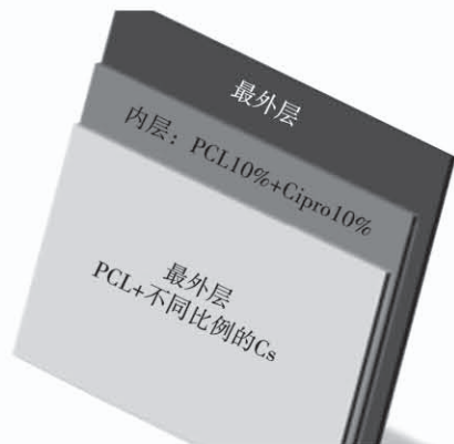
图11 三层夹心结构的纳米复合多层纤维膜
